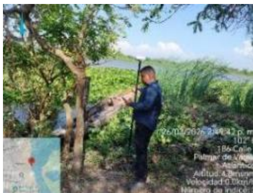
Imagen 19. Amarre de referencia a mojones nivelados.
